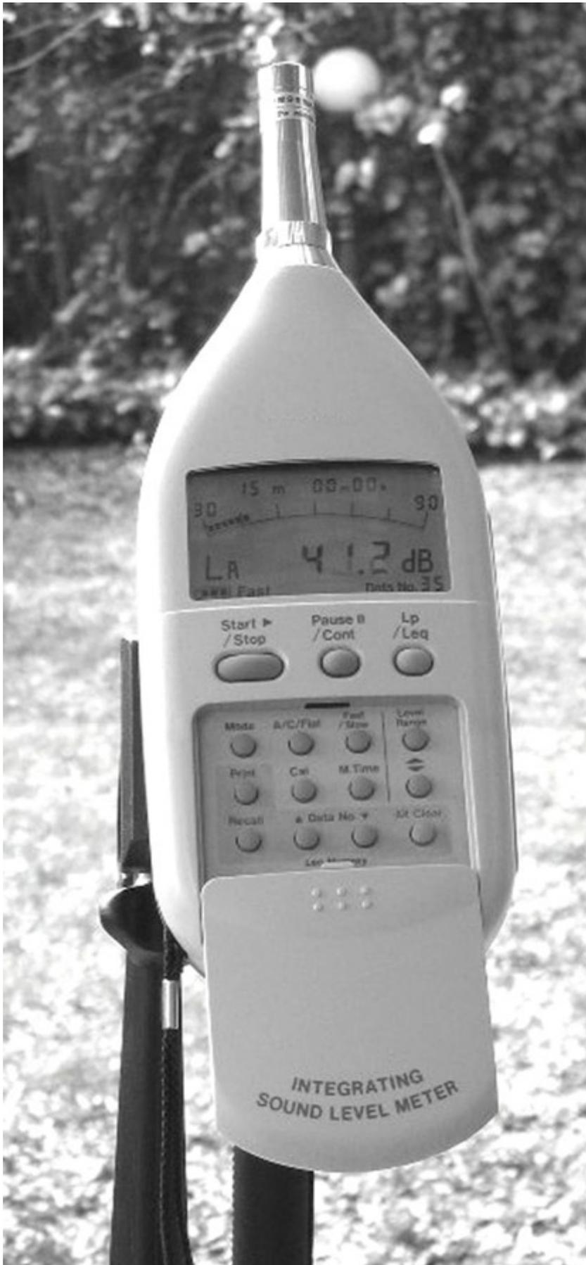
**Figura 6.** Medidor de nivel sonoro
