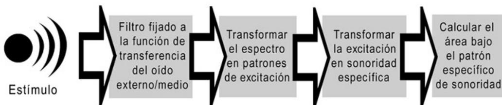
**Figura 20.** Modelo de Moore en bloques para calcular la sonoridad
