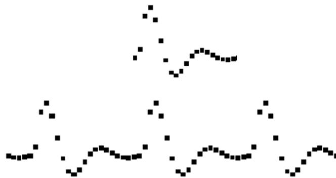
**Para analizar en una computadora un conjunto de muestras finito, se repiten y se utiliza la DFT.**
